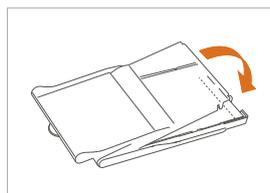
4. Große **Klappe** der Schublade mit einem Klick **schließen**. Kleine offen lassen.
